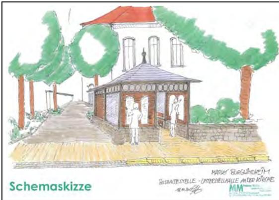
Die Unterstellhalle wird als modern gestaltete Stahlkonstruktion mit einem Walmdach orientiert an die früher typische Dachform für öffentliche oder gemeinschaftliche Gebäude nutzungen gestaltet.
